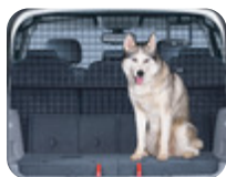
Перегородка для багажу на всю висоту салону Для встановлення за 2-им рядом сидінь, окрема додаткова рама також дозволяє встановлювати за 1-им рядом сидінь – З: 2006 –
