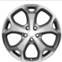
Легкосплавний колісний диск 18" 5-спицева конструкція (Y-подібна форма), передні – кольору «антрацит», верстатної обробки 8 x 18", ET 55, для шин 235/45 R18 – Лише в комбінації з обмежувачем рульової рейки, До: 03/2010
