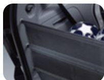
Подовжувач перегородки для багажу Чорна, доповнює бар'єр для утримання багажу, збільшуючи його висоту, не дозволяє багажу випасти, коли відчинено двері багажного відділення
