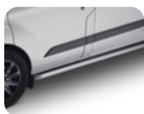
ARP* Бокова захисна дуга Полірована трубчаста конструкція з нержавіючої сталі з кутовими вигинами
