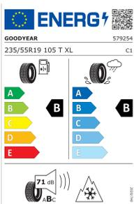
Kraftstoffeffizienz: B, Nasshaftung: B, Abrollgeräusch: B, dB: 71
