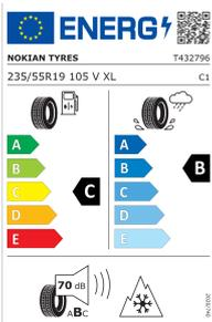
Kraftstoffeffizienz: C, Nasshaftung: B, Abrollgeräusch: B, dB: 70
