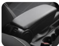
**Bracciolo Con porta USB integrata per caricare la batteria di un dispositivo mobile**
