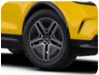
20" Alüminyum Alaşım Jant Ön, 5 x 2-jant teli tasarımı, Mutlak Siyah ve Parlak İşlenmiş. 8 x 20", ofset 45, lastikler için 235/50 R20. Montaj için gerekli, uygun karşılık gelen 9 x 20" arka tekerlek (FINIS 2689778)
