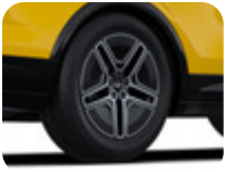
20" Alüminyum Alaşım Jant Arka, 5 x 2-jant teli tasarımı, Mutlak Siyah ve Parlak İşlenmiş. 9 x 20", ofset 35, lastikler için 255/45 R20. Montaj için gerekli, uygun karşılık gelen 8 x 20" ön tekerlek (FINIS 2689776)
