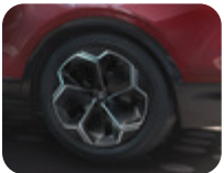
21" Alüminyum Alaşım Jant Arka, 5 kollu tasarım, Asfalt Siyah ve Parlak İşlenmiş 9 x 21", 35 ofsetli, 255/40 R21 lastikler için. Montaj için uyumlu 8 x 21" ön jant gereklidir (FINIS 2707040)
